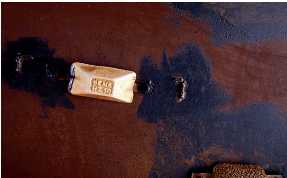
Veneen sinkkianodi ollut Saimaalla yli 20 vuotta ja siinä ei näy kulumisen merkkejä.
