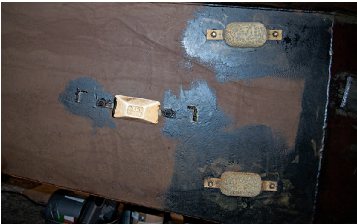
Kulmikas anodi on sinkkianodi ja pyöreäkulmainen on magnesiumanodi.
